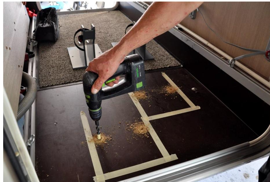
**Legen Sie den Aufnahmeschuh auf Seite und bohren Sie mit einem 12er Bohrer ein 10 mm tiefes Loch. Achtung nicht durchbohren. Tipp: mit Kreppband die Tiefe am Bohrer markieren.**
