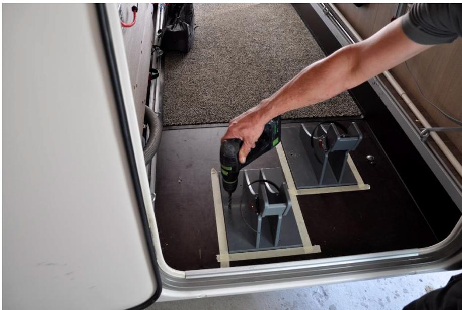
**Nun markieren Sie das Loch für die Einnietmutter der Aluplatte mit einem 8er Bohrer**
