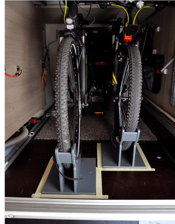
Nun markieren Sie die Position der Aufnahmeschuhe mit Kreppband.
